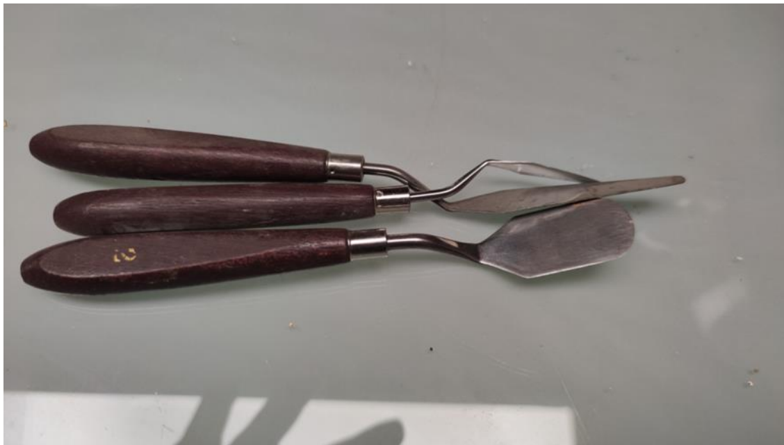
Fig. 2. Espátulas realizadas utilizando mangos de cucharillas viejas de plata, que se han insertado en los mangos de espátulas comerciales.
